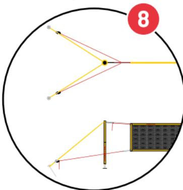
Die optimale Netzposition erreichst du durch Nachjustieren der Spanngurte und der unteren Spannleinen. Das Netz sollte genau in der Flucht der Netzpfeosten hängen.
