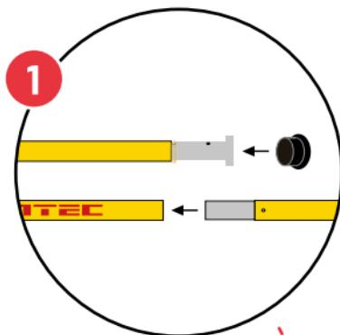
Setze die Netzpfosten aus je zwei Rohrteilen zusammen und stelle die schwarze Kunststofffußstücke unter das Aluminium-Fußteil. Das untere Rohr hat ein höhenverstellbares Fußstück.
