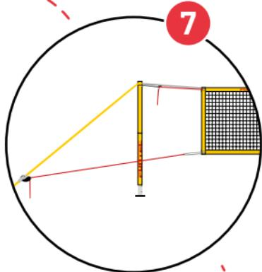
Spanne alle vier Spanngurte gleichmäßig ab und stelle die Netzpfeosten dabei senkrecht. Die schwarzen Haken werden in die Metallschnallen der Spanngurte eingehängt. Die gewünschte Netzspannung und genaue Netzhöhe stellst du über die unteren roten Spannleinen ein.
