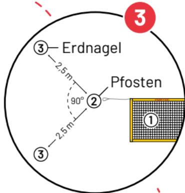
Die Positionen der Erdnägel werden folgendermaßen festgelegt: Entfalte dazu vollständig das Netz (1). Die Schlaufen des oberen Spannseils markieren die Positionen der Netzpfosten (2). Von hier aus werden die Erdnägel in einem 90°-Winkel in einer Entfernung von ca. 2,5 m platziert (3).
